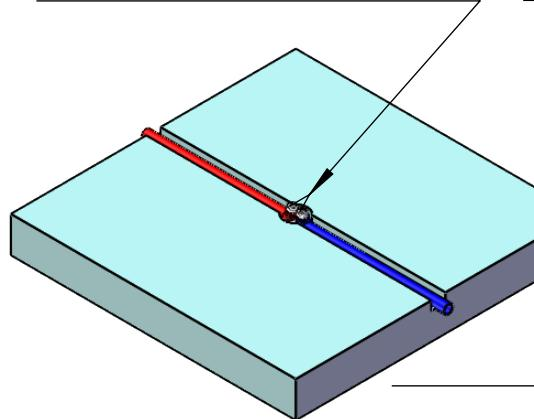
Das Loch mit einem Durchmesser von 12 mm und einer Tiefe von 57-60 mm bohren
