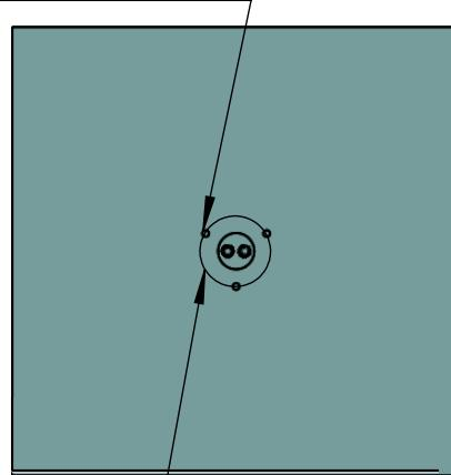
3 Spreizhülsen in die 3 Löcher einsetzen
